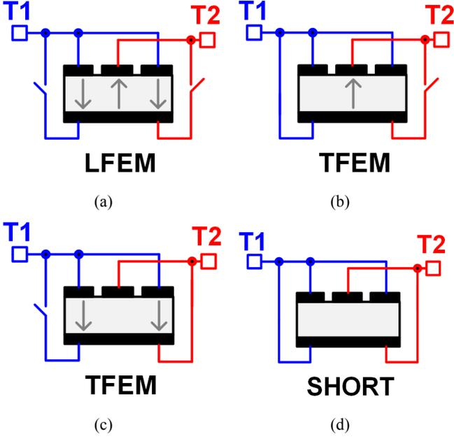
**Fig. 2:** (a) LFEM, (b) TFEM-HI, (c) TFEM-LO, and (d) SHORT mode reconfiguration. [6]
